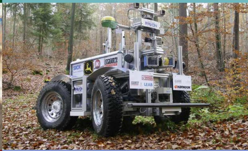
**12****Autonomer Roboter sammelt Landminen**
